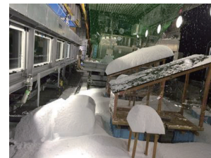
図1 ワックス添加塗料の落雪状況(奥:フッ素系塗料)
