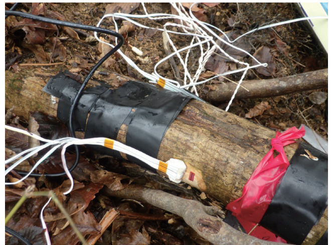
図1 計測に使用したひずみゲージと、その設置状況。
