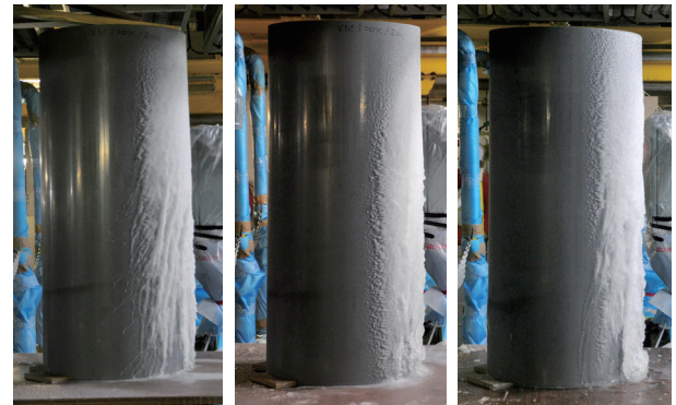
図 2 \phi 500\text{mm} の塩ビパイプ上の飛沫着氷。左 : 10 m/s, 240 \mu\text{m} , 中 : 7.5 m/s, 240 \mu\text{m} , 右 : 7.5 m/s, 120 \mu\text{m} 。
